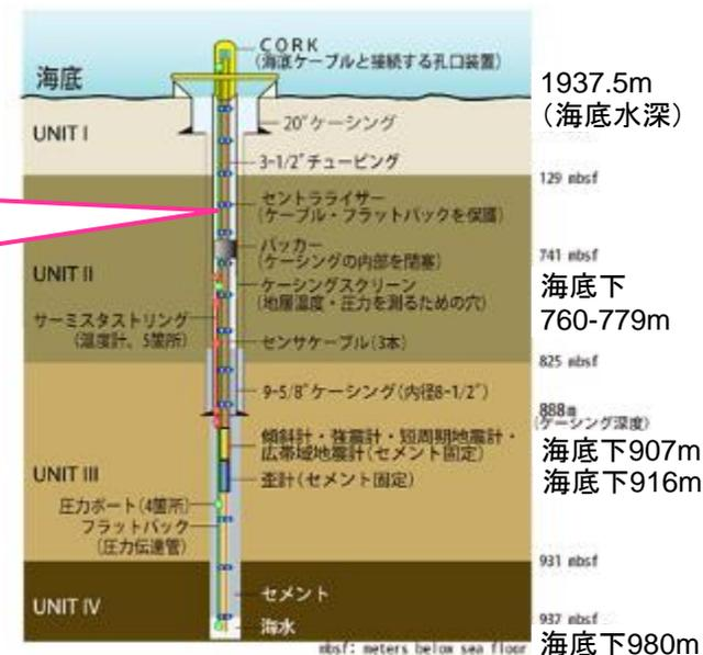
地震動・地殻変動の複合計測システム
