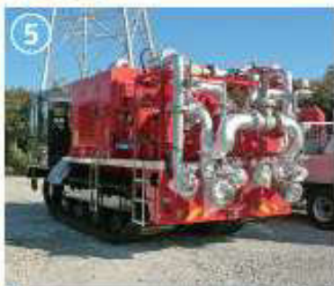
可搬型の注水ポンプ
