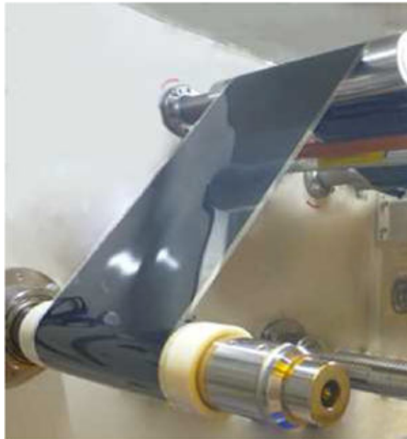
ロールtoロールによる製造
